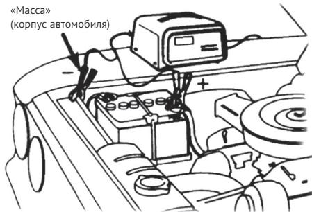
*В автомобилях с обратной полярностью подключения батареи – подключайте отрицательный контакт (чёрная клипса) зарядного устройства к «-» контакту аккумулятора, а положительный (красная клипса) – к корпусу автомобиля.*
