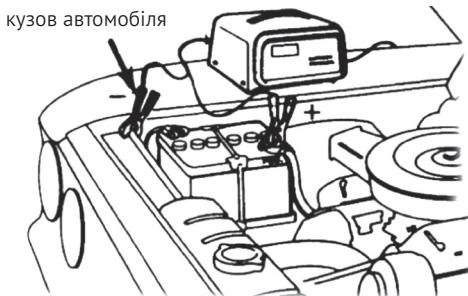
*В автомобілях зі зворотною полярністю підключення батареї – підключайте негативний контакт (чорна кліпса) зарядного пристрою до «-» контакту акумулятора, а позитивний (червона кліпса) до корпусу автомобіля. Уникайте підключення кліпс поблизу карбюратора, паливопроводів.*
